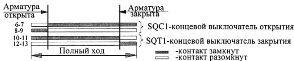
Рис.5. Электрическая схема соединения электромагнитов управления и концевых выключателей отсечной пневмоприводной быстродействующей арматуры (нормально закрытой и нормально открытой) при установке под оболочкой и вне оболочки
